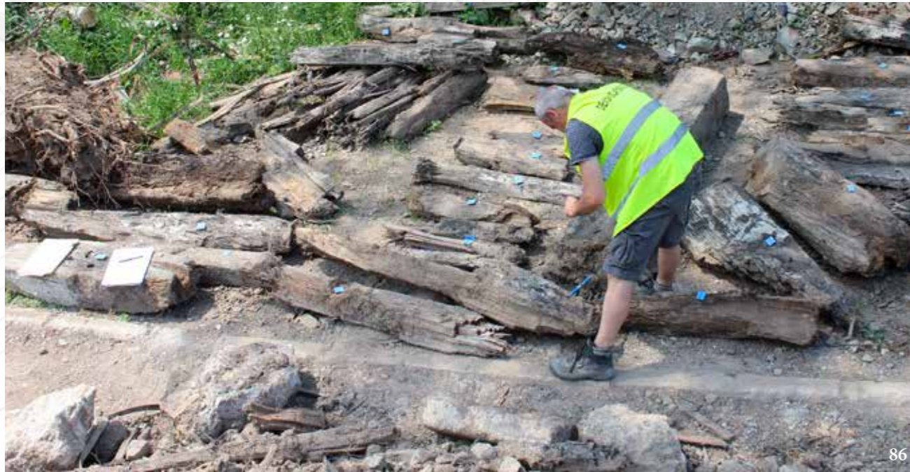
Počtená kolekce dřevěných prvků souvisejících s náhonem a fungováním mlýna. Odběr vzorků pro dendrochronologické datování, které na základě analýzy letokruhů umožňuje určit stáří dřeva s přesností na kalendářní rok.
